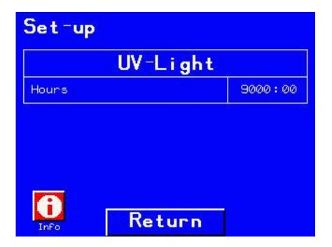
In der oberen linken Ecke ('set-up') 5 Sekunden drücken, um den Timer zurückzusetzen.
